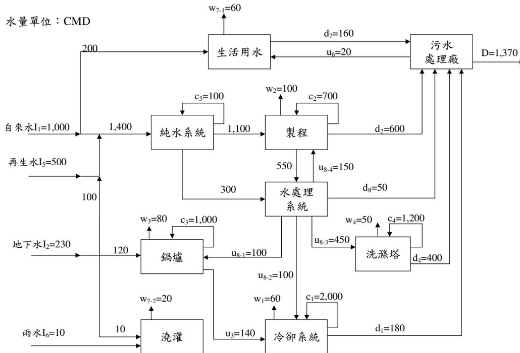
圖五 一般工廠用水平衡圖繪製範例
