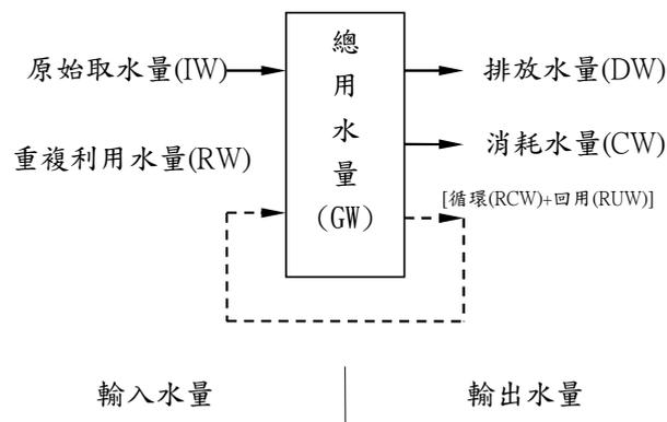
圖三 水平衡系統分析示意圖
